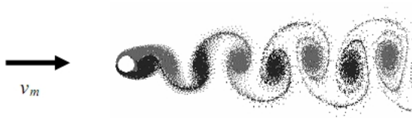
Figura III.6.1 Siajul von Karman pentru o secțiune circulară [1]
