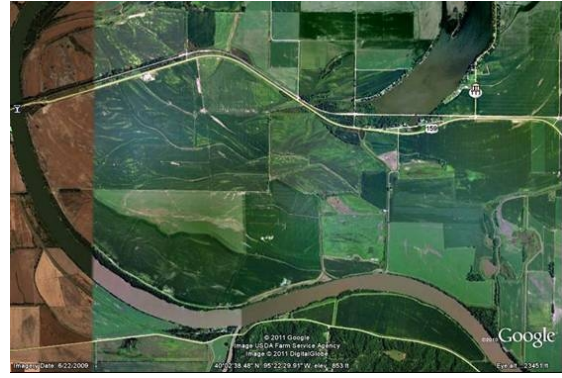
Figura III.2.6 Categoria II - Terenuri cu iarbă și/sau cu obstacole izolate (copaci, clădiri) aflate la distanțe de cel puțin 20 de ori înălțimea obstacolului ( z_0 = 0,05 m) [5]
