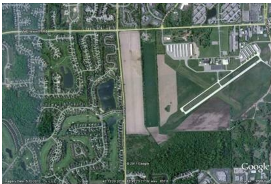
Figura III.2.7 Categoria III - Zone acoperite uniform cu vegetație, sau cu clădiri, sau cu obstacole izolate aflate la distanțe de cel mult de 20 de ori înălțimea obstacolului (de ex., sate, terenuri suburbane, păduri) ( z_0=0,3 m) [5]
